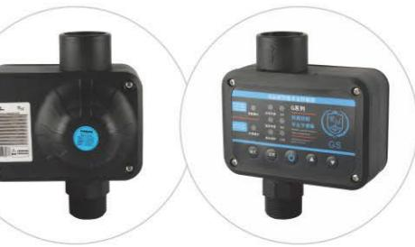
**3. 缺水保护:** 在智能模式和水塔模式下，系统检测无水流且管内压力低于启动值时，即进入缺水保护状态，系统将在8秒后停机。保护停机状态下若触发流量开关动作或压力高于启动值时即启动水泵运行。
